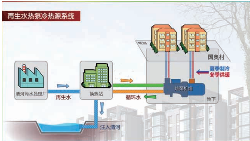
▲ 图1 奥运村再生水热泵系统流程示意图
